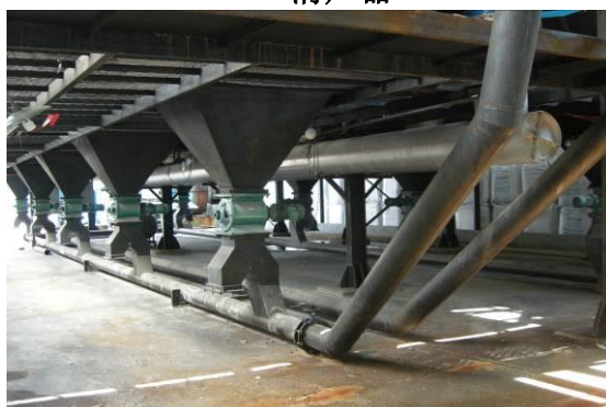
除尘器密闭除灰系统及除尘灰(微硅粉)包装
