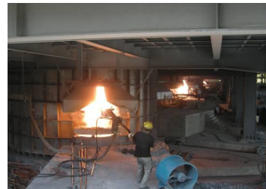
3#、4#12500KVA 半密闭矮烟罩矿热电炉出硅口集气罩
