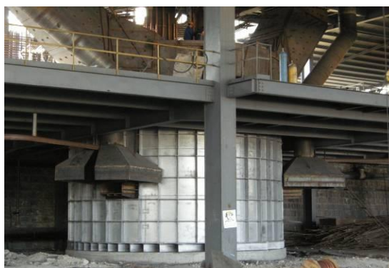
3#、4#12500KVA 半密闭矮烟罩矿热电炉出硅口集气罩
