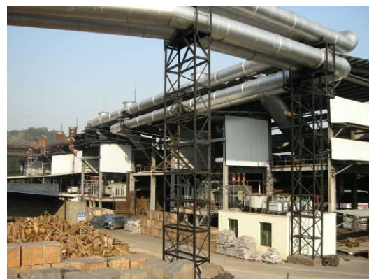
12500KVA 半密闭矮烟罩矿热电炉及变压器
