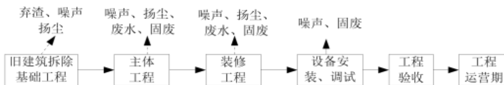
图 3-1 施工期工艺流程及产污节点图
