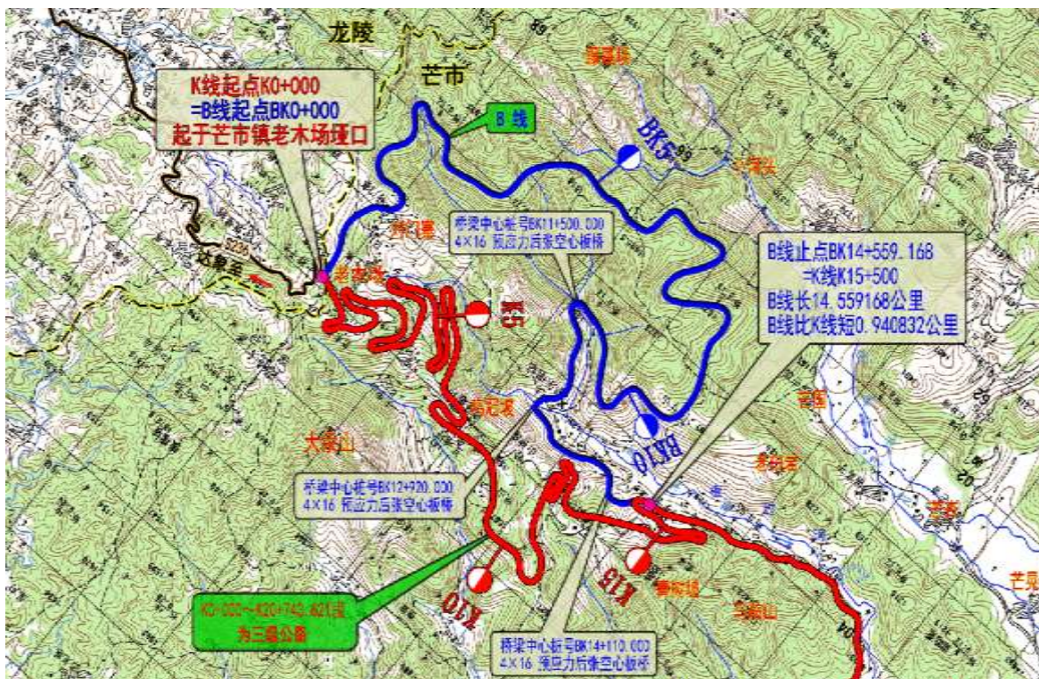
图 7.2-1 K 线与 B 线方案比较平面图
