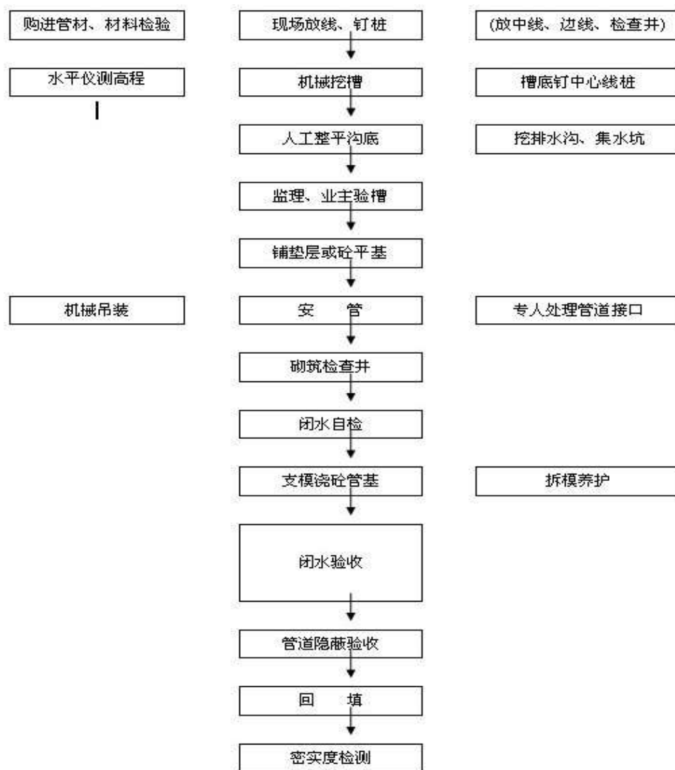
图 2.7-2 给排水工程施工工艺示意图
